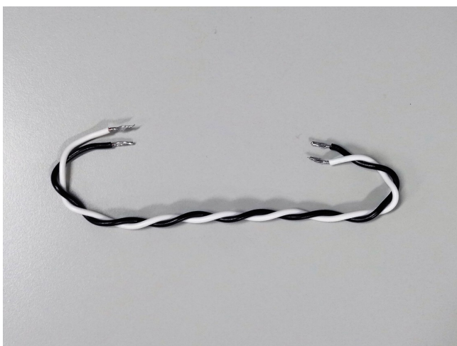
Fig. 14: モータードライバ間電源ケーブル 10cm 1 本
