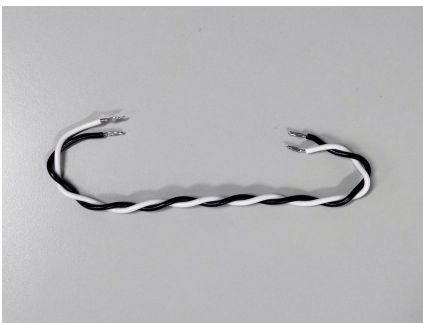
Fig. 32: モータードライバ間電源ケーブル
