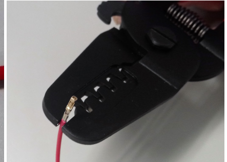
Fig. 26: ピンが開いている場合は、平行になるように整える
